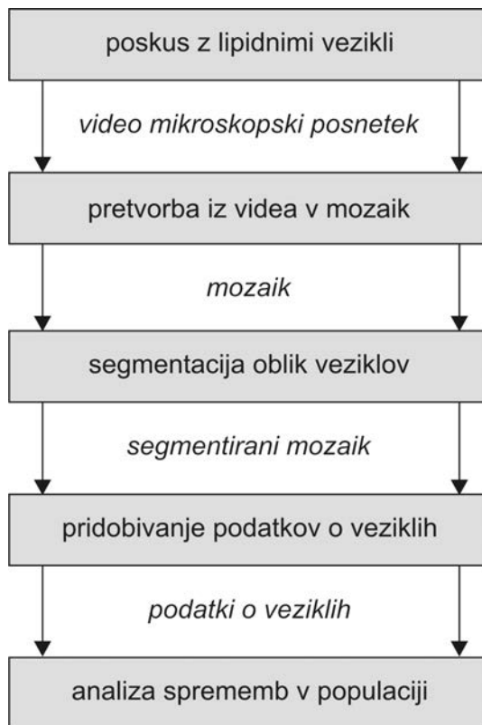
Slika 2 Potek korakov v predstavljeni metodologiji za analizo populacij lipidnih veziklov. Potemnjeni pravokotniki predstavljajo korake, poševni tisk pa njihove izhode.
