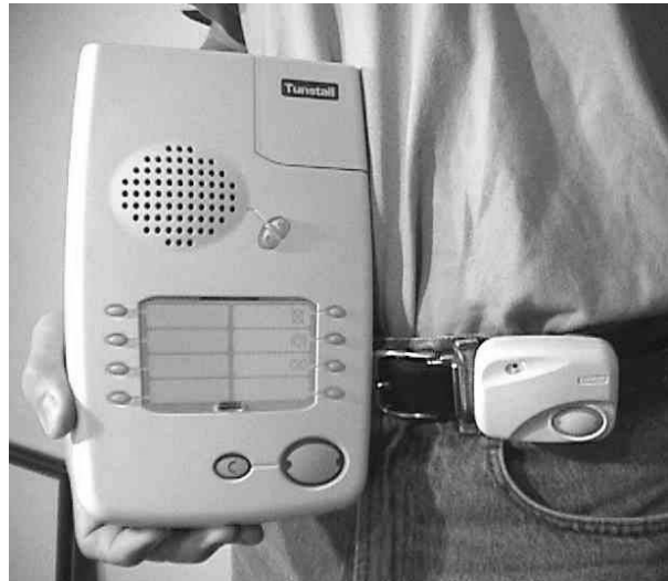
Slika 4 Detektor padca, ki deluje tudi v sistemu oskrbe na domu na daljavo (Tunstall, Vel.Britanija).
