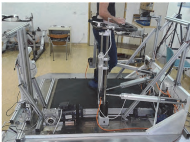
Slika 4 Eksperimentalna platforma za evalvacijo: sistem BART in naprava za spotikanje med hojo prostovoljca po tekočem traku.
