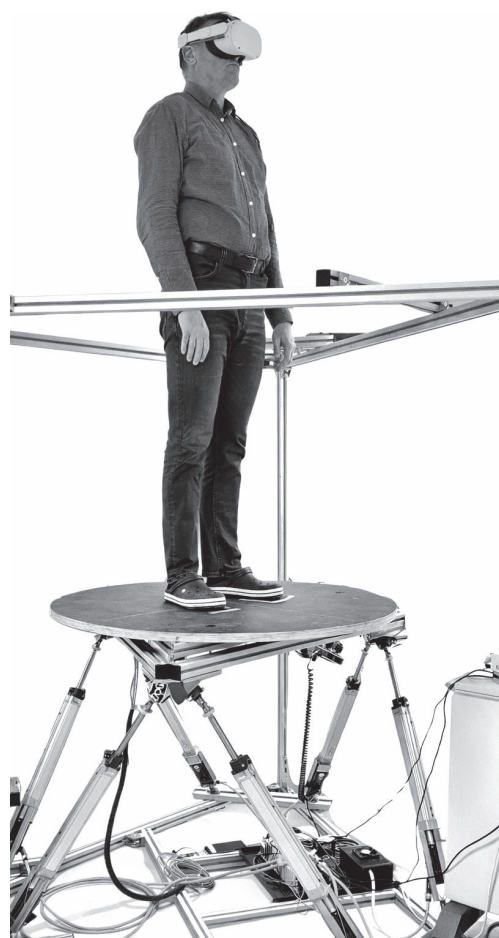
Slika 1 Udeleženec meritve stoji na Stewartovi ploščadi, medtem ko z očali za navidezno resničnost opazuje poglobljeno navidezno resničnost vožnje z avtobusom.
